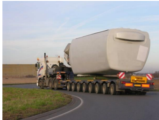
Photo 155 : transport de nacelle (VALOREM)
